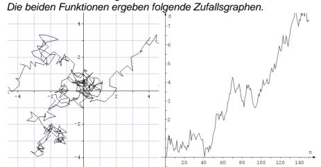
d) Die Erhöhung der Temperatur erhöht die Teilchengeschwindigkeit. Betrachtet man bei verschiedenen Temperaturen dasselbe Zeitintervall  $\Delta t$ , so wird die mittlere Wegstrecke  $\Delta s$  größer. Das kann man in der Simulation durch Vergrößerung des Intervalls [-0,5 / 0,5] zum Ausdruck bringen. Dadurch wächst der Diffusionsradius schneller, wie man auch im Foto sieht.
