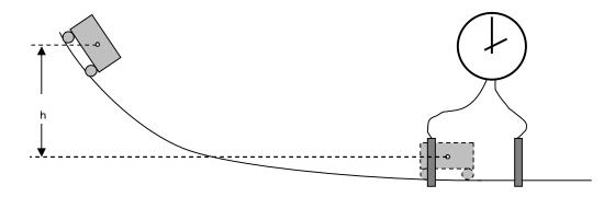
Zur Bestimmung der Abhängigkeit der Bewegungsenergie von der Geschwindigkeit lässt man einen Versuchswagen (möglichst geringe Reibung, Räder mit geringem Trägheitsmoment), dessen Masse zunächst unverändert bleibt, aus verschiedenen Höhen h eine schiefe Ebene hinunterfahren. Eine rollende Stahlkugel als bewegter Körper eignet sich nur sehr bedingt, da 2/7 der Gesamtenergie stets in Form von Rotationsenergie gebunden sind.
